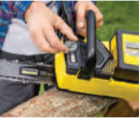
Visor del depósito de aceite
