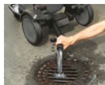
Manguera de desagüe incorporada
