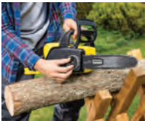
Tensado de la cadena sin herramientas
